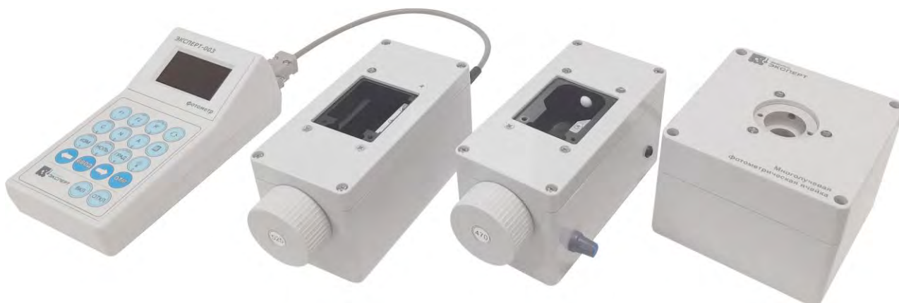
Рисунок 4 – Внешний вид фотометра модификации ЭКСПЕРТ-003-1 слева направо: ИП, ячейка ФЯ-1 с подключенным источником излучения, ячейка ФЯ-1МТ с подключенным источником излучения, ячейка ФЯ-2
